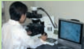
位相差分散顕微鏡を用いたアスベストの計数
