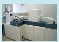
高分解能GC/MSによる測定
