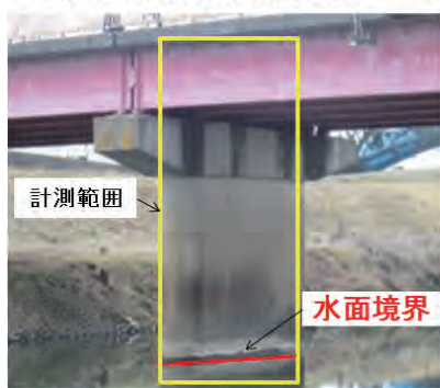
輝度変化を利用した水位計測の実理
