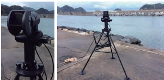
写真1 水中3Dスキャナ (左:本体、右:三脚で固定した状態)
