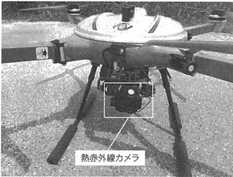
熱赤外線カメラ搭載ドローン
