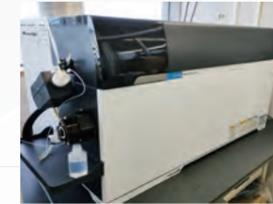
誘導結合プラズマ-タンデム質量分析計(ICP-MS/MS)
