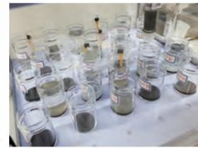
鉄鋼スラグ活用材を利用した気中・水中のCO<sub>2</sub>吸収試験
