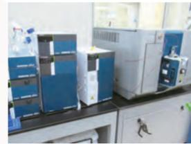
高速液体クロマトグラフ-タンデム質量分析計 (LC-MS/MS)
