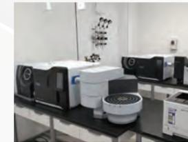
ガスクロマトグラフ-タンデム質量分析計(GC-MS/MS)
