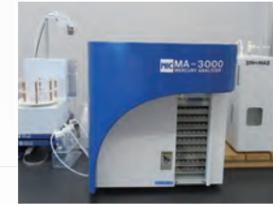
加熱酸化水銀測定装置
