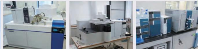
環境または生体試料中の極微量化学物質を分析するため、高精度分析機器(高分解能GC-MS、GC-TOF/MS、LC-MS/MS、ICP-MSなど)を備えたケミカルハザード対応の分析室(2F、4F)。放射能の測定室、生態影響試験室、はちみつの製造所などを配置(1F)。
