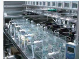
魚類試験装置(流水式曝露)
