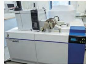
ガスクロマトグラフ-二重収束型質量分析計 (GC-DFMS)
