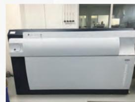
飛行時間型タンデム質量分析計(MALDI-TOF/TOF-MS)
