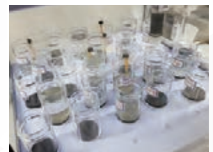
鉄鋼スラグ活用材を利用した 気中・水中のCO 2 吸収試験
