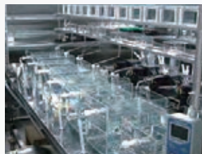
魚類試験装置(流水式曝露)
