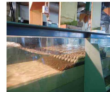
人工リーフ洗掘対策の効果確認のための水理模型実験
