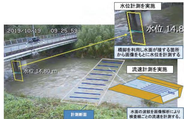
カメラ映像から水位・流速を同時に計測
