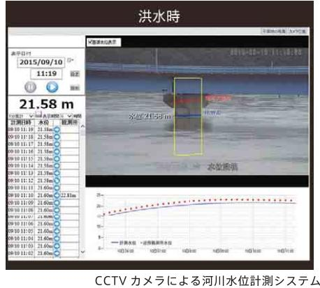
CCTV カメラによる河川水位計測システム
