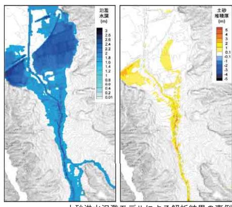
土砂洪水氾濫モデルによる解析結果の事例
