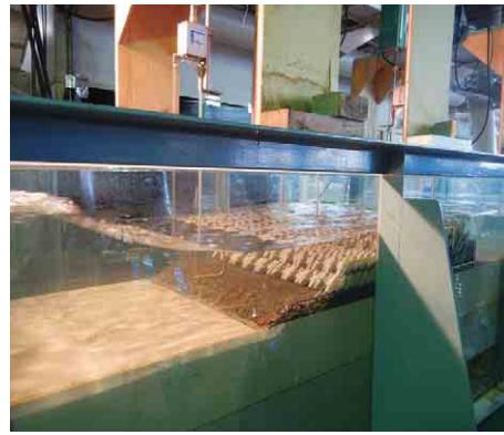
人工リーフ洗堀対策の効果確認のための水理模型実験
