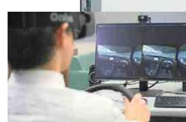
ドライビングシミュレータによる道路安全性評価
