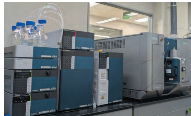
PFASの測定分析に使用する分析装置 (LC-MS/MS)
