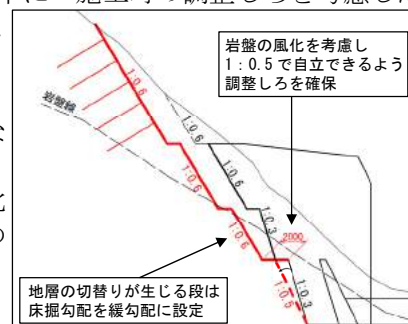
図-4 床掘勾配の緩勾配化
