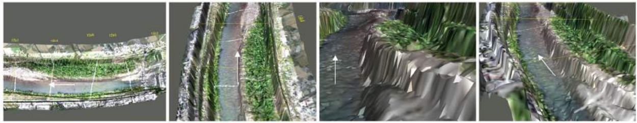
図-6 現況河道の河川 CIM 構築結果
