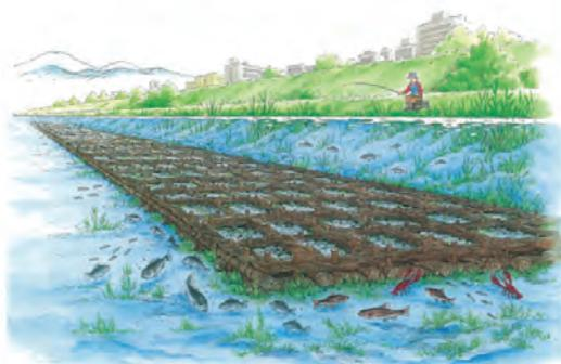
粗朶沈床(図1)は、広葉樹の枝を束ねて格子状に組み、石を投じて水面下に沈め、河床の根固めなどに利用するものです。全体の構造が柔軟性に富むことから、沈設後の河床変動にも追従し、河床を常に覆い固めることが可能です。また、自然の素材を用いるため、長期的にみても環境を汚染する心配がありません。さらに、その多孔性により、魚などの水生生物の生息環境の創造が期待される工法です。
