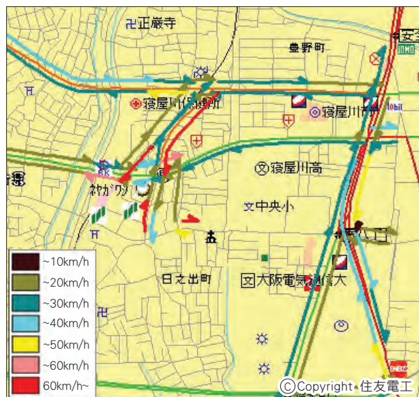
図4 旅行速度の解析結果の表示例(任意エリア)
