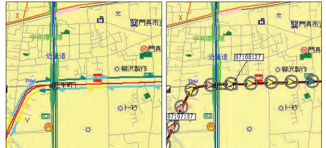
図2 DRM上の車の軌跡(左)とプローブデータの取得地点(右) (左図の特定コースに沿った点データの取得地点を、右図の◎印で示す)
