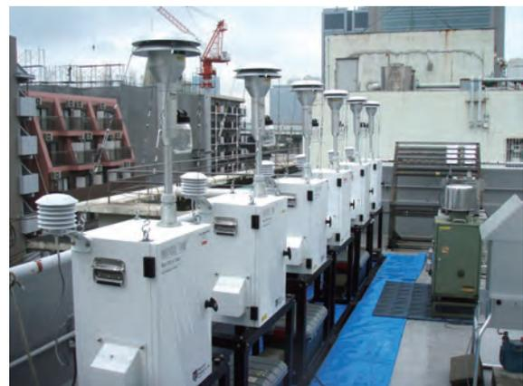
写真2 当社PM2.5サンプラーによる並行試験状況
