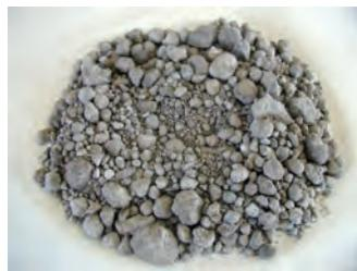
転炉系製鋼スラグは日本全国で年間約1,000万t(2006年度実績)が生成されており、耐摩耗性や水硬性の性質があることから、主に道路用路盤材や地盤改良材に有効利用されています。
