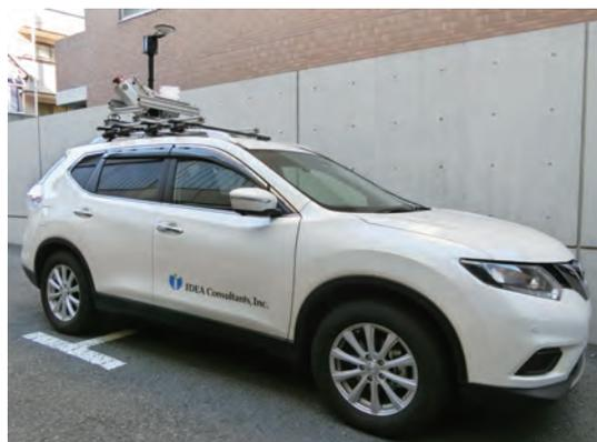
図7 MMS搭載車両外観
