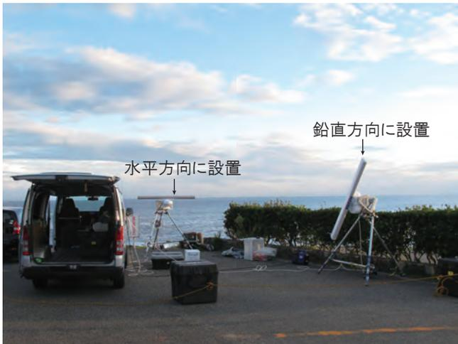
写真3 船舶レーダ設置状況
