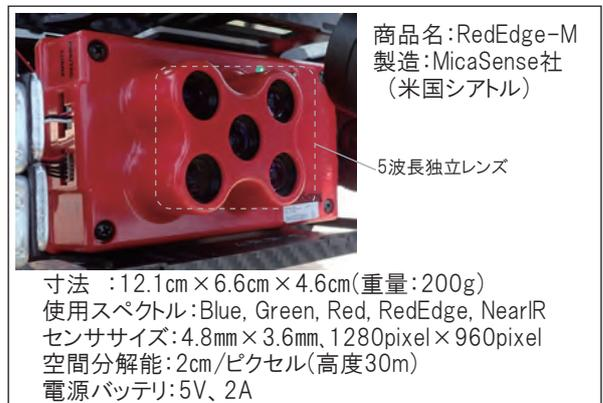
図2 使用したマルチスペクトルカメラ
