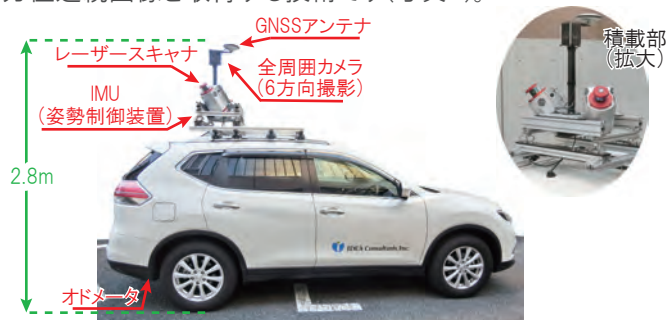
写真2 MMS調査車両
