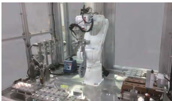
写真3 PCB前処理の自動化装置
