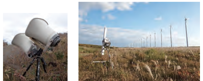
写真1 効果検証に使用したスピーカー(左)と船舶レーダ(右)
