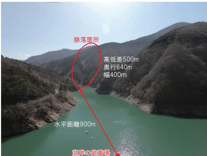
写真2 崩落箇所の状況
