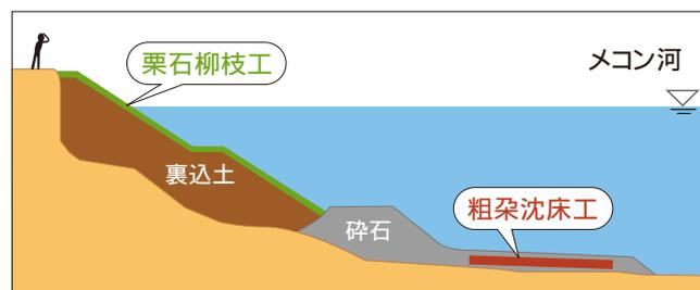
図2 パイロット護岸工事の断面図
