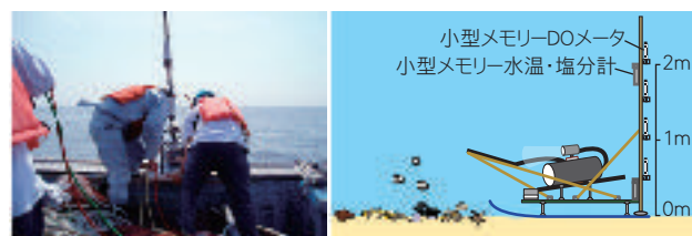
図3 海底での貧酸素調査とDOメータの取り付け位置
