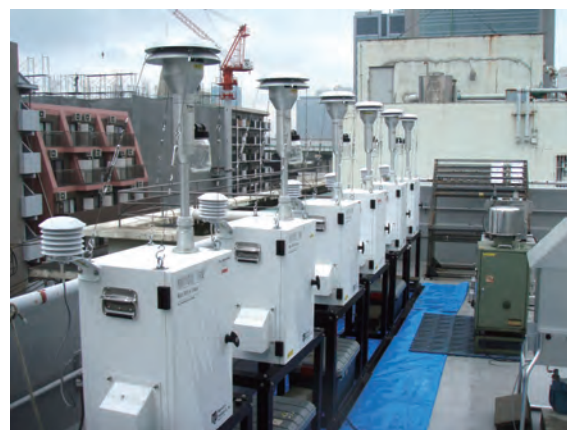
写真2 当社PM2.5サンプラーによる並行試験状況 (出典:大阪府微小粒子状物質(PM2.5)実態調査報告書)
