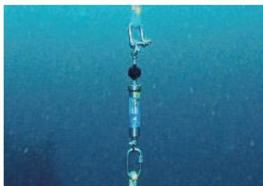
写真2 電磁流速計
