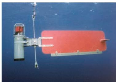
写真1 ベルゲン型流向流速計
