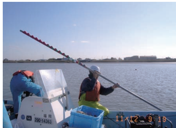
写真2 河床変動モニタリング装置の外観
