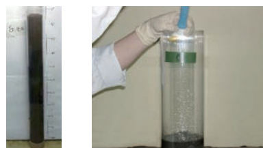
写真1 汚染土壌の不溶化のためのカラム実験(左)と散布をイメージした不溶化剤の添加状況(右)
