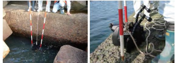
写真2 水中カメラによる鋼矢板腐食状況調査
