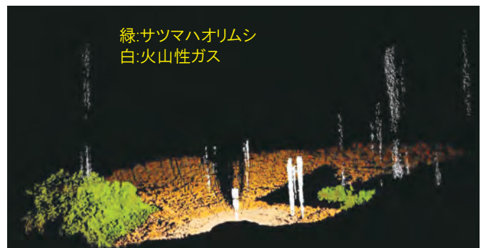
図8 水中3Dスキャナによるサツマハオリムシコロニーと火山性ガス噴出状況
