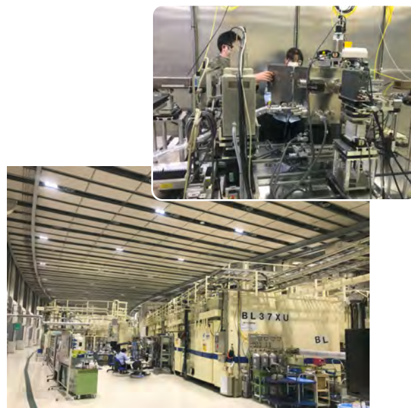
写真2 SPring-8 (BL37XU)での放射光測定の様子 (右上)実験ハッチ内の走査型顕微分光計測装置
