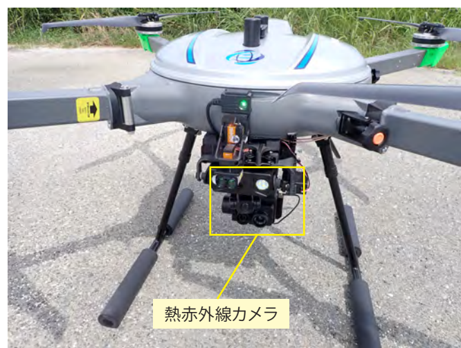
図1 ドローン(SKY-Mapper Mark II、TPホールディングス社製) ※「政府機関等における無人航空機の調達等に関する方針について」に準拠
