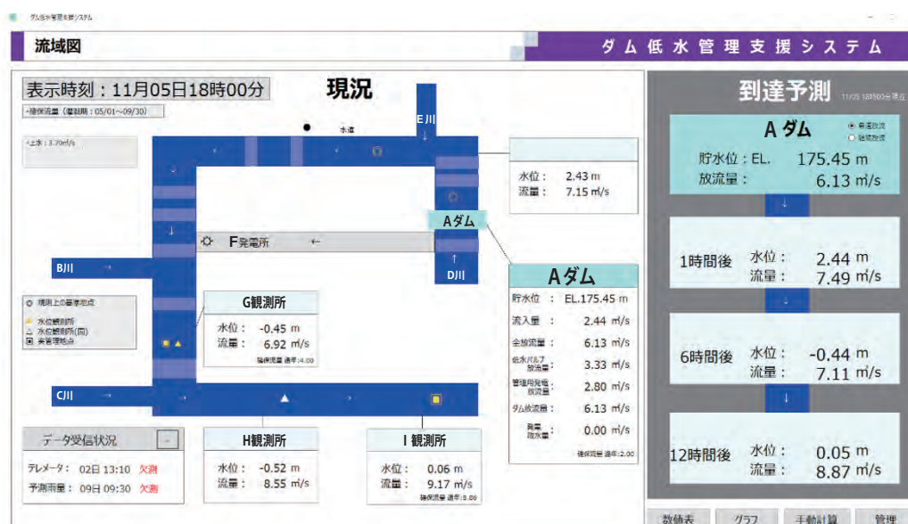
図5 ダム流水管理支援システムのイメージ(低水)
