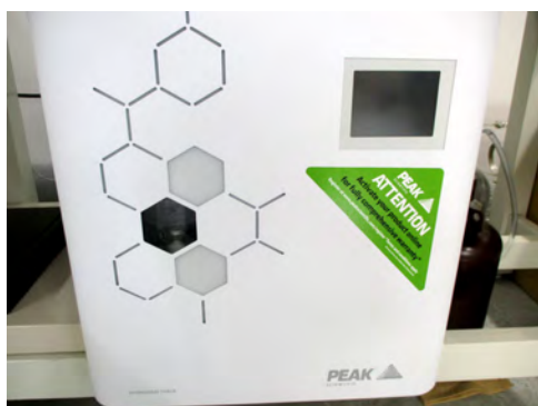
図2 水素ガス発生装置
