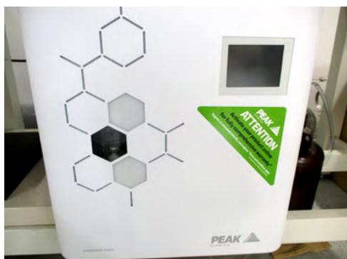
図2 水素ガス発生装置
