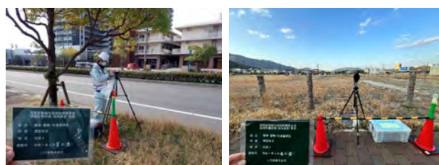
図7 現地調査の状況(左:交通量調査、右:騒音・振動)
